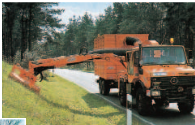
Absaugung von Böschungen
